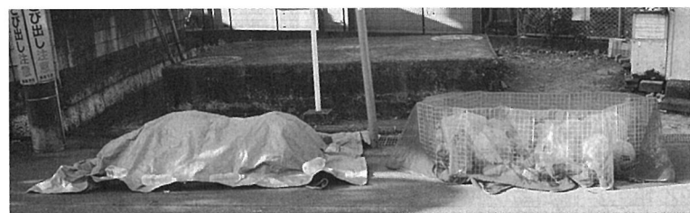
カラス被害防止サークル試験状況 左は従来方法、右はサークル使用
